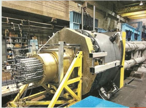
Test de fatigue pour un haubon de 139 torons aus USA
